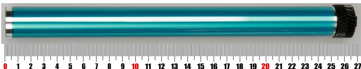
3. Покрытие на барабане прозрачное (свет отражается от алюминиевой поверхности барабана), это покрытие имеет при обычном освещении зеленые оттенки. Общая длина барабана 267 мм.
