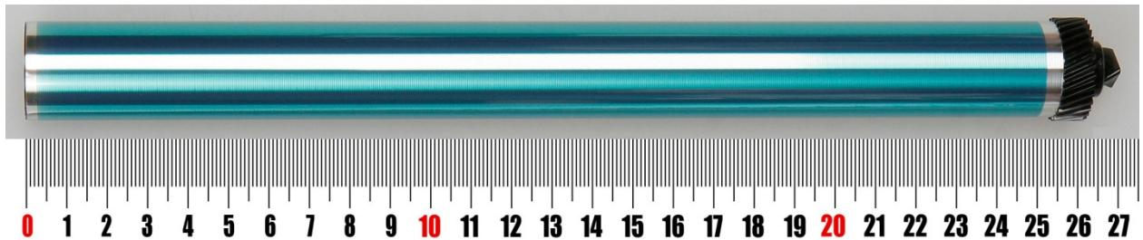
3. Покрытие на барабане прозрачное (свет отражается от алюминиевой поверхности барабана), это покрытие имеет при обычном освещении зеленые оттенки. Общая длина барабана 272 мм.
