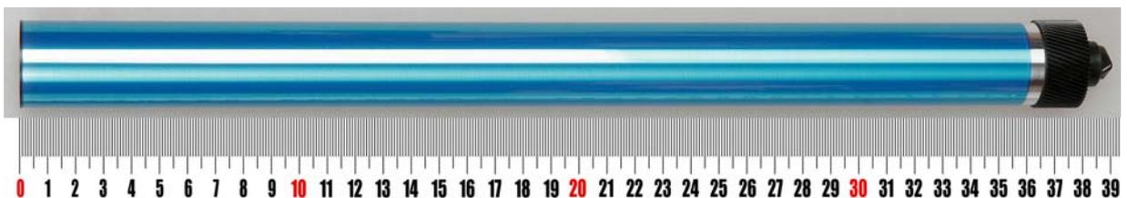
3. Покрытие на барабане прозрачное (свет отражается от алюминиевой поверхности барабана), это покрытие имеет при обычном освещении синие оттенки. Общая длина барабана 387 мм.
